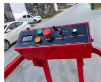
上控制器 Upper controller
