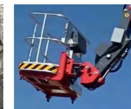
超轻铝合金工作篮 Ultra-light aluminum alloy work basket
