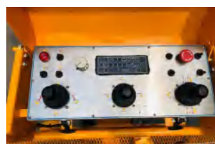
平台控制器 Platform Controller
