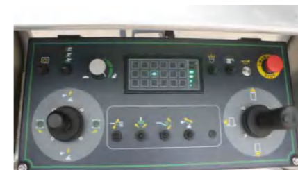
工作台控制器 Workbench controller
